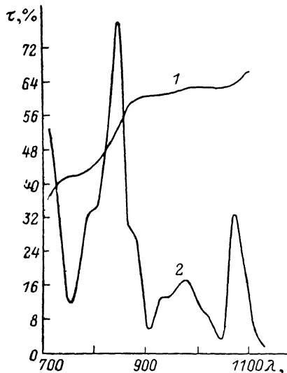
Рис. 3. Спектральная кривая (1) и дифференциальный спектр (2) пропускания фотокатода \text{Na}_2\text{KSbCsO} .
