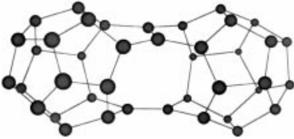
Рис. 6. Кластер C_{40} , в который переходит кластерная молекула (C_{20})_2 в результате слияния двух фуллеренов C_{20} .
