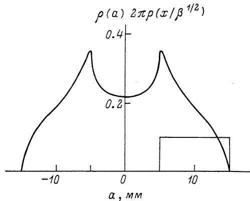
в установках с сильным затуханием для обеспечения полного и равномерного вывода электронов наиболее целесообразным представляется использование параметрического резонанса. В остальных случаях инжектируемый пучок формируется таким образом, чтобы его функция распределения  $\rho(a)$  по амплитудам была близка к ступенчатой
