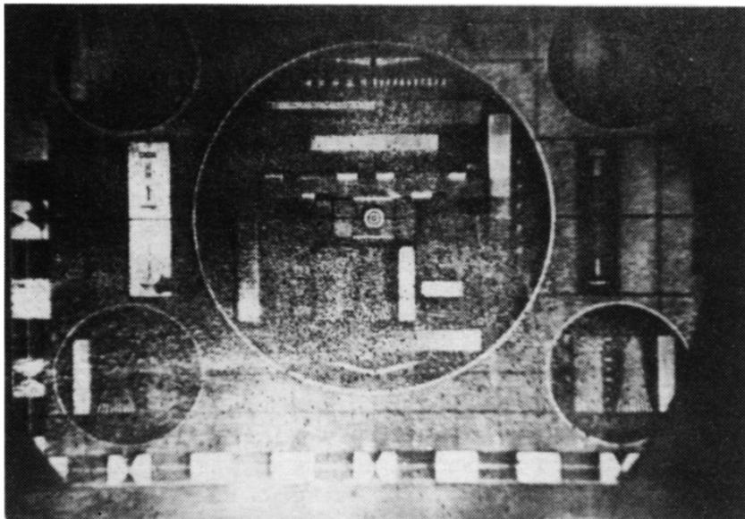
Фотоснимок изображения тест-таблицы, записанного на структуру сегнетоэлектрический жидкий кристалл - фотопроводник: интенсивность возбуждающего излучения  $9 \cdot 10^{-5}$  Вт/см<sup>2</sup>; время экспонирования 200 мс; напряжение питания 10 В; диаметр большого круга 7 мм.
