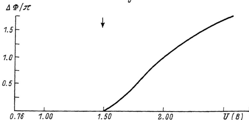
Полученная с помощью интерферометра Майкельсона зависимость фазовой задержки от напряжения: а – интерферограмма, визуализирующая эту зависимость и порог включения электрооптического эффекта в слое ЖК; б – результат калибровки интерферограммы:  $\lambda = 0.633$  мкм, толщина слоя ЖКМ-654 (по номенклатуре НИОПиК) 10 мкм, сопротивление резистивного слоя 450 кОм/см, частота прикладываемого напряжения не более 1 кГц. Стрелкой показан порог включения электрооптического эффекта в слое ЖК.
