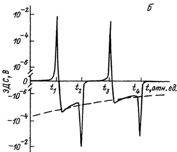
Зависимость поверхностной намагниченности  $M$  (а) и ЭДС (б) от времени на участке с линейной зависимостью  $H(t)$  – сплошные линии. Те же величины в классическом пределе – штриховые кривые.
