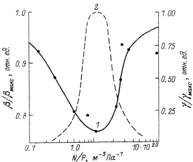
Коэффициенты растворения (кривая 1) и неидеальности (кривая 2) для холодной неравновесной плазмы газового разряда ( $n_e \sim 10^{14} \text{ см}^{-3}$ ,  $T_e \sim (1-2) \cdot 10^3 \text{ К}$ ,  $T \sim 300-400 \text{ К}$ ), полученной при полном давлении влажного воздуха  $\rho \sim 0.1-1.0 \text{ кПа}$ .
