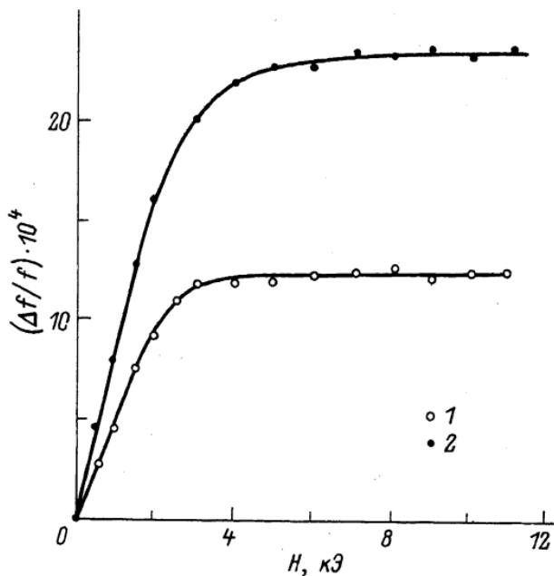
Зависимость относительного изменения резонансной частоты от напряженности магнитного поля для составов, содержащих: 1 - 20% и 2 - 40% феррита никеля.
