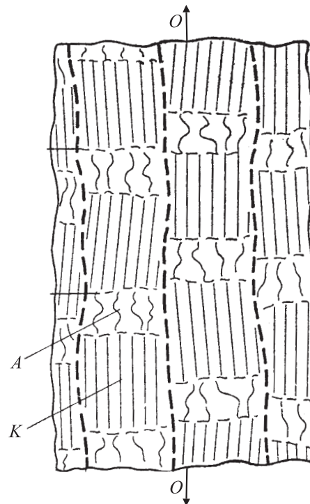
Рис. 6. Схема строения ориентированного аморфно-кристаллического полимера. O—O — ось ориентации образца. Штриховые линии — приблизительные границы между фибриллами. K — кристаллит, A — аморфная область (межкристаллитная прослойка).
