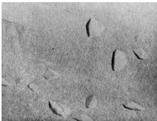
Рис. 3. Поверхность пленки ZnO на кремнии. Толщина пленки 0,8 мкм, увеличение \times 24000 .
