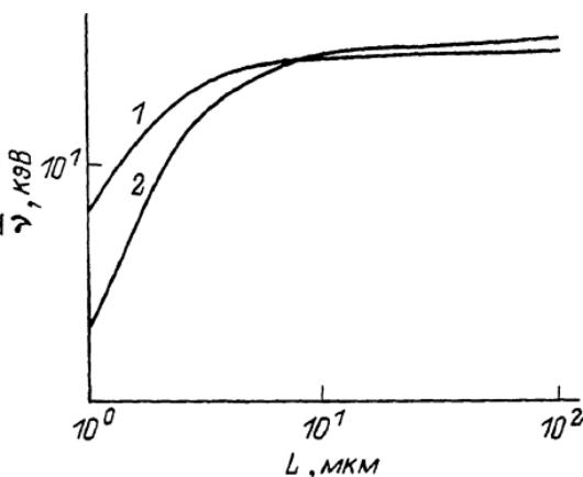
Зависимость эффективной каскадной функции  $\bar{y}$  от толщины  $L$  мишени по направлению пучка. 1 -  $\bar{v}_{inel}$ , 2 -  $\bar{v}_{el}$ .
