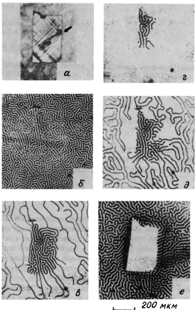
а) Фотография исследуемого монокристалла  $YBa_2Cu_3O_{7-x}$  в отраженном поляризованном свете. Видна его двойниковая структура.
