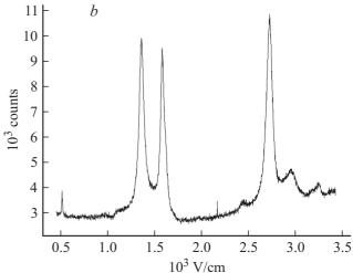
**Рис. 2.** a — спектры КР гетероструктуры, термически обработанной при  $T \approx 800^{\circ}$ С, b — спектры КР гетероструктуры, термически обработанной при  $T \approx 1100^{\circ}$ С.
