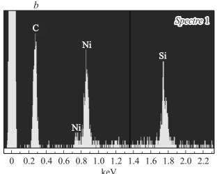
**Рис. 3.** a — РЭМ изображение исходной гетероструктуры, b — спектры РМА исходной гетероструктуры.
