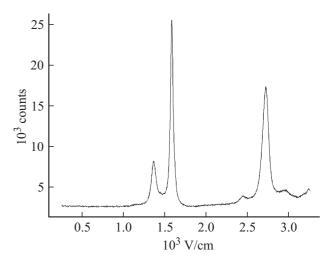
**Рис. 6.** Спектры КР поверхности "обращенной" гетероструктуры, термически обработанной при  $T\approx 1100^{\circ}{\rm C}$ .
