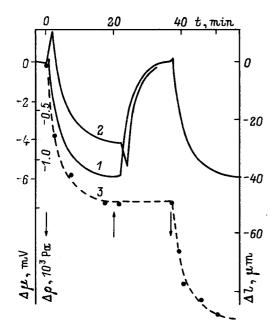
Отклики датчиков на приложение нагрузки к пористому образцу  $YBa_2Cu_3O_{6+x}$ . I,2—  $ZrO_2$ -датчик в терминах приращения давления кислорода  $\Delta p$  и химического потенциала атомов кислорода  $\Delta \mu$ , 3— механический индикатор в терминах приращения длины образца  $\Delta l$ . T (°C): I,3— 555, 2— 450. Стрелки, направленные вниз и вверх, указывают время приложения и снятие нагрузки соответственно.
