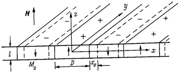
**Рис. 1.** Модель доменной структуры одноосной высокоанизотропной ферромагнитной пленки.  $l$  — толщина пленки,  $D$  — ширина домена в отсутствие поля,  $x_0$  — смещение границы от исходного положения.
