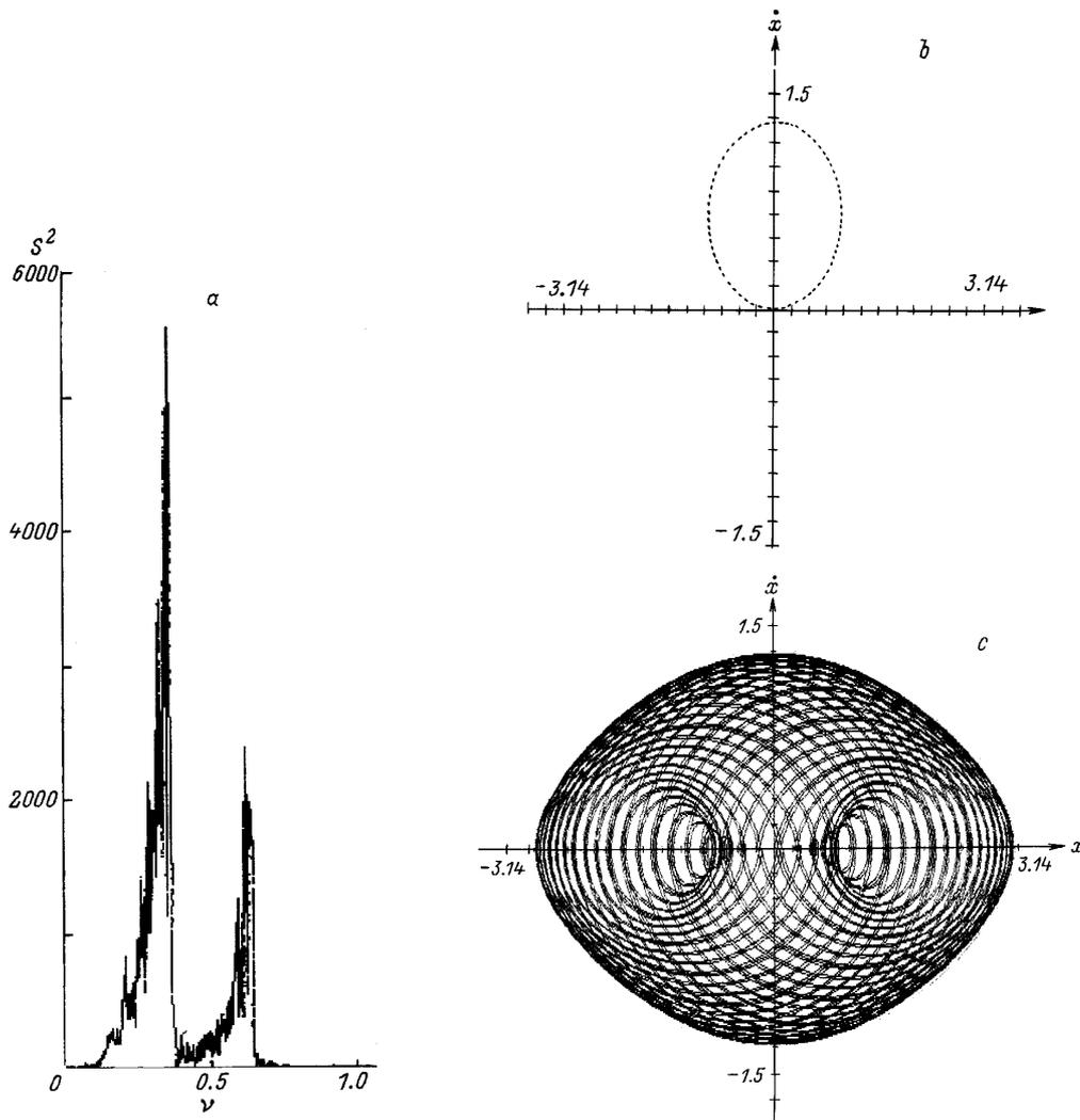
**Рис. 3.** Спектральная плотность колебаний системы ДГ при  $\omega = 0.3$ ,  $h = 0.03$  (а); сечение Пуанкаре (б) и фазовый портрет (с) этих колебаний.
