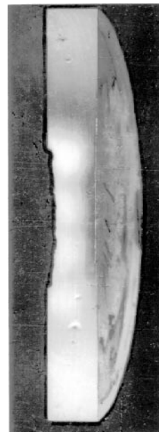
Рис. 4. Разрез диска из ПММА толщиной 8 мм, облученный электронным пучком с плотностью тока j = 1.6 \text{ кА/см}^2 .
