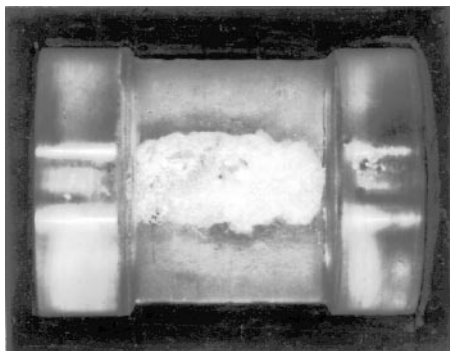
Рис. 6. Цилиндр из ПММА с плоской внутренней стороной, облученный электронным пучком с плотностью тока j = 1.5 \text{ кА/см}^2 .
