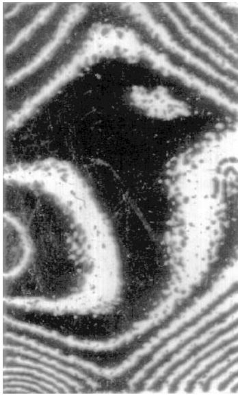
Рис. 4. Интерференционная топограмма исследуемой тонкой алюминиевой пластины, характеризующая форму рельефа поверхности.
