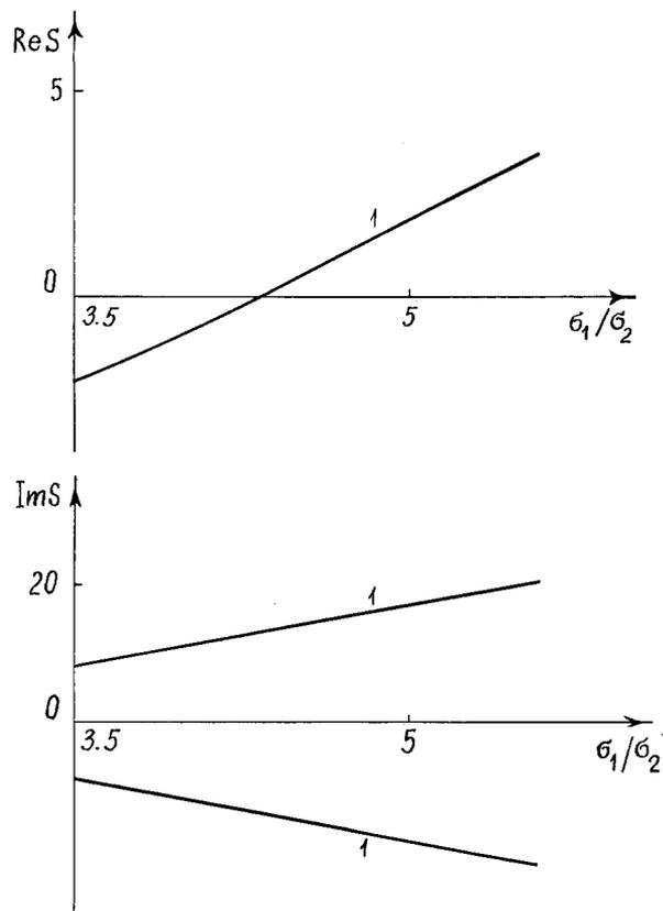
Зависимости вещественной  $\text{Re}S = \text{Re}S(\sigma_1/\sigma_2)$  и мнимой  $\text{Im}S = \text{Im}S(\sigma_1/\sigma_2)$  компонент частоты капиллярных движений жидкости от отношения удельных проводимостей верхней  $\sigma_1$  и нижней  $\sigma_2$  жидкостей при  $k = 1$ ,  $\nu = 0.1$ ,  $\varepsilon = 0.1$ ,  $\rho = 0.01$ ,  $\beta = 0.01$ ,  $W = 2.15$ .
