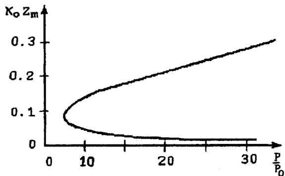
**Рис. 2.** График зависимости положения максимума профиля поля в нелинейной среде  $k_0 z_m$  от нормированного потока  $P/P_0$ .
