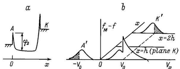
**Рис. 1.** Схема изменения потенциала в кнудсеновском зазоре от катода  $K$  к аноду  $A$  (*a*) и схема изменения функции  $\delta f = f_M - f$  (*b*).  $A$  и  $A'$  — в реальном зазоре при  $x = 0$  (в плоскости анода); от  $A$  при  $x = 0$  и  $K'$  при  $x = 2h$  — в эквивалентной постановке задачи при  $x = 2h$ . Область скоростей, дающая вклад в ток на анод, заштрихована.
