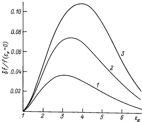
**Рис. 2.** Отличие  $\delta f = f_M - f$  ФРЭ от максвелловской в зависимости от продольной энергии  $\epsilon_x$  при  $u_{\perp} = 0$  и нескольких значениях параметра  $h/l_e$ . 1 — 0.2, 2 — 0.1, 3 — 0.05. Отношение  $\epsilon_0 = \varphi_2/T$  равно 4,  $u_{\perp} = 0$ .
