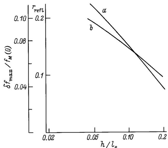
**Рис. 3.** Зависимость максимума функции  $\delta f$  от  $h/l_e$  при  $u_{\perp} = 0$ ,  $\epsilon_0 = \varphi_2/T = 4$  (a) и аналогичная зависимость коэффициента отражения (b).
