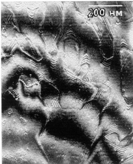
Рис. 2. Изображение антифазных границ в системе GaAs/Ge/GaAs(001), полученное методом просвечивающей электронной микроскопии.
