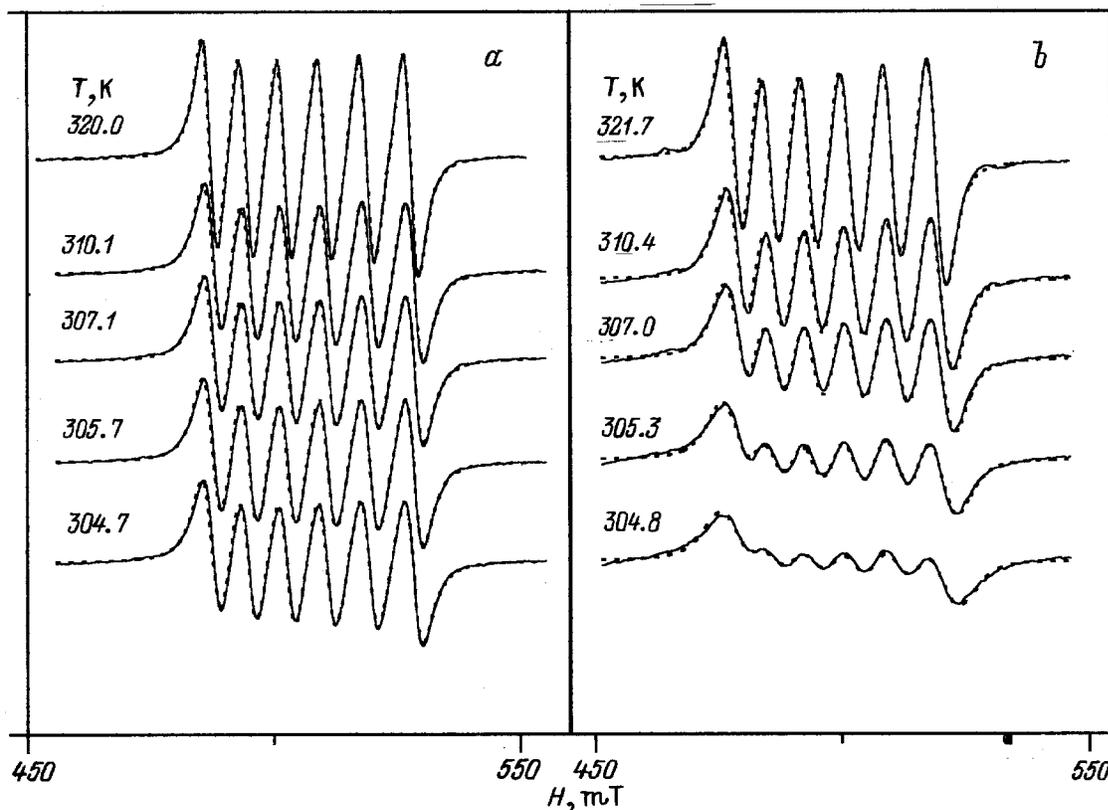
**Рис. 1.** Фрагмент ЭПР-спектра кристаллов  $\text{Rb}_2\text{ZnCl}_4:\text{Mn}^{2+}$ , соответствующий сверхтонкой группе  $M_S = 3/2 \leftrightarrow 5/2$ , в высокотемпературной окрестности  $T_i = 304.4\text{ K}$ .  $a - \mathbf{H} \parallel \mathbf{a}$ ,  $b - \angle \mathbf{H}, \mathbf{a} = 7^\circ$ ,  $\mathbf{H} \perp \mathbf{b}$ . Штриховыми линиями показаны расчетные спектры, полученные сверткой лоренцевой и гауссовой функций.
