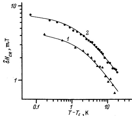
**Рис. 3.** Зависимости критического вклада в ширину линии  $\delta H_{CR}$  от  $(T - T_i)$  в двойном логарифмическом масштабе. 1 —  $\angle \mathbf{H}, \mathbf{a} = 3.5^\circ$ , 2 —  $\angle \mathbf{H}, \mathbf{a} = 7^\circ$ ;  $\mathbf{H} \perp \mathbf{b}$ . Сплошные линии получены при помощи выражения (4).
