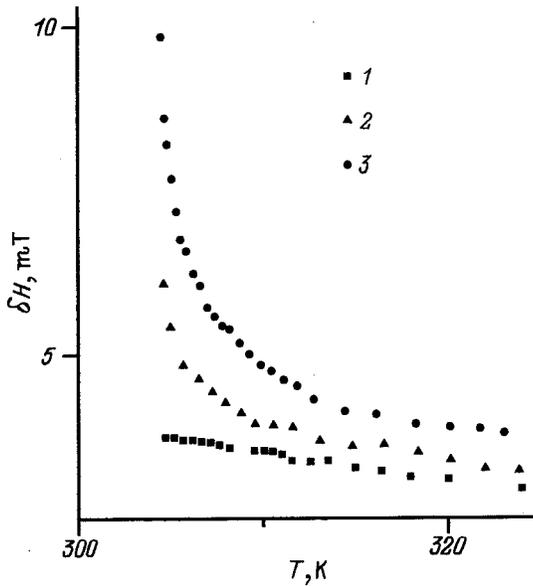
**Рис. 2.** Температурная зависимость ширины индивидуальной сверхтонкой компоненты перехода  $M_S = 3/2 \leftrightarrow 5/2$  для следующих ориентаций внешнего магнитного поля: 1 —  $\mathbf{H} \parallel \mathbf{a}$ ; 2 —  $\angle \mathbf{H}, \mathbf{a} = 3.5^\circ$ ; 3 —  $\angle \mathbf{H}, \mathbf{a} = 7^\circ$ ;  $\mathbf{H} \perp \mathbf{b}$ .
