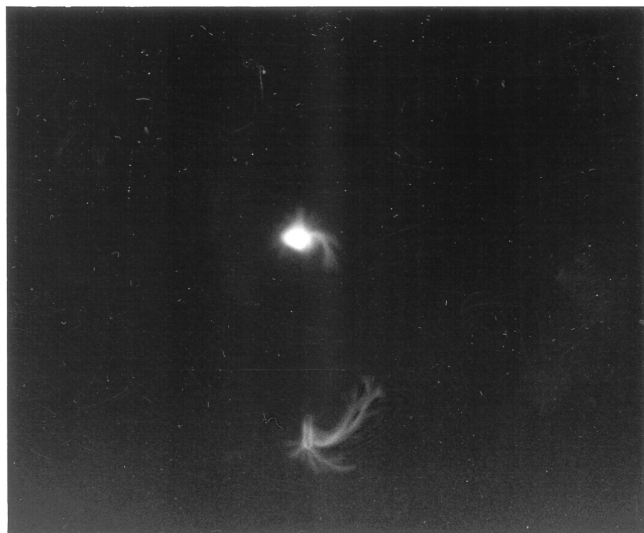
Рис. 4. Привязанный к инициатору глубоко подкритический СВЧ разряд в воздухе: \tau = 40 \mu\text{s} , 2L = 3 \text{ cm} , 2a = 8 \cdot 10^{-2} \text{ cm} .
