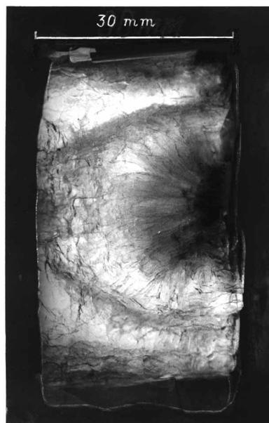
Рис. 5. Образец аэрогеля после воздействия электронного пучка.
