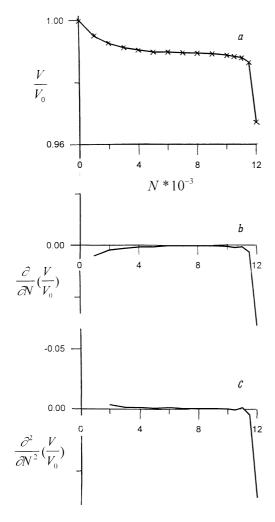
a — зависимость скорости звука в образцах из стали 45 от числа циклов нагружения  $V^*(N)$ . (Асимметричный цикл, амплитуда 200 MPa, частота нагружения 1 Hz). b — первая производная  $\partial V^*/\partial N=\xi_1(N)$ . c — вторая производная  $\partial^2 V^*/\partial N^2=\xi_2(N)$ .
