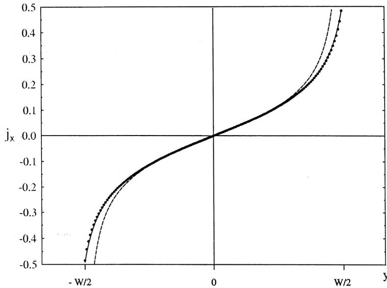
**Рис. 1.** Распределение экранирующей плотности тока по ширине пленки. Точки — численный расчет уравнения (3), пунктирная линия — распределение ЭТ, полученное в [2], сплошная линия — аппроксимация (4),  $H^{ext} = 0.01$ ,  $W/\lambda_{eff} = 20$ .
