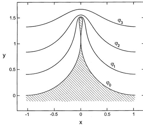
Один период стационарного профиля свободной поверхности жидкого металла во внешнем электрическом поле для критического значения волнового числа  $k = k_c \approx 3.042$ . Приведены соответствующие различным значениям параметра  $\varphi$  ( $\varphi_1 = -0.07$ ,  $\varphi_2 = -0.19$  и  $\varphi_3 = -0.42$ ) эквипотенциальные поверхности; на границе жидкого металла  $\varphi = \varphi_0 = 0$ .
