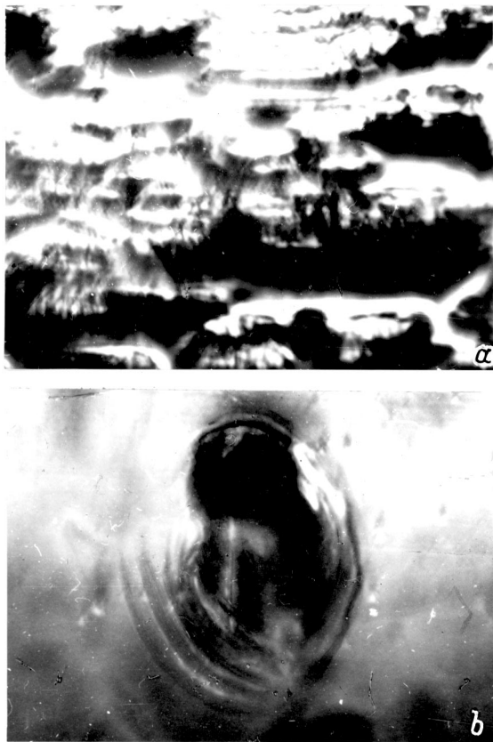
Рис. 1. Поверхностный рельеф (а) и кольцевые пластические сдвиги (b), охватывающие дефект типа кратер на пленке \text{Pd}_{84.5}\text{-Si}_{15.5} , деформированной растяжением до разрушения при T = 0.5 \text{ K} ( \times 750 ).
