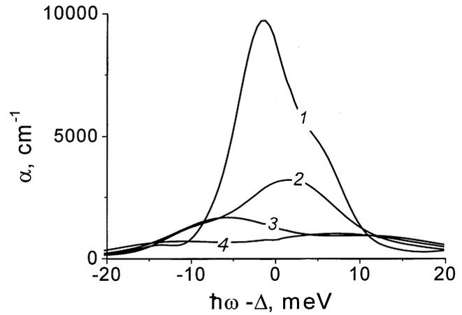
**Рис. 4.** Зависимость коэффициента поглощения от частоты в периодической гетероструктуре GaAs/AlAs при разных значениях электрического поля, вычисленная по формуле (31) с  $f = 1$  для гетероструктуры, спектр которой представлен на рис. 1. Линиям 1–4 соответствуют поля 5, 9, 12, 15 кВ/см.
