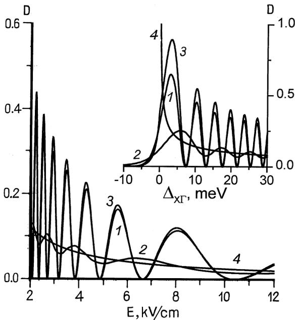
**Рис. 3.** Зависимость вероятности бесфононного перехода  $\Gamma_2-X_z1$  при движении электрона от  $k_0 = -\infty$  до  $k_1 = \infty$  (линия 1) и от  $k_0 = 0$  до  $k_1 = \infty$  (линия 2) от величины электрического поля. Компонента волнового вектора электрона, перпендикулярная полю, равна нулю. Линия 3 получена с помощью выражения (9), а линия 4 — с помощью (10). На вставке изображены зависимости вероятности бесфононных переходов от  $\Delta_{X\Gamma}$  в поле 2 кВ/см.
