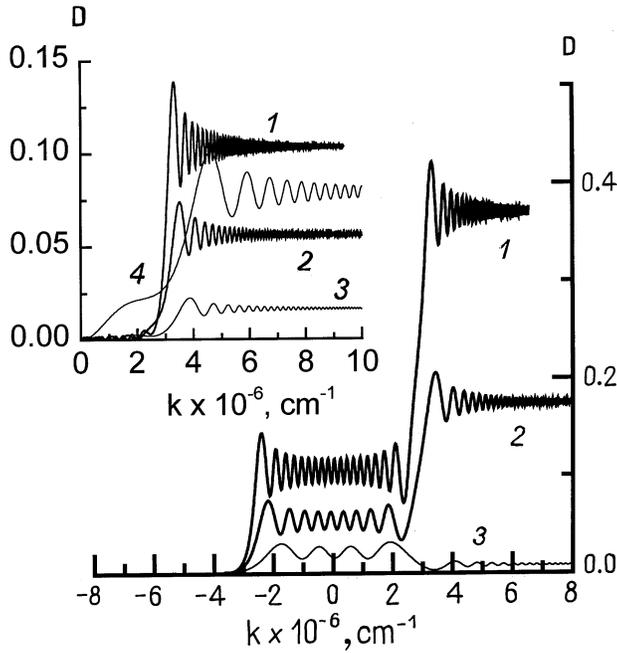
**Рис. 2.** Зависимости вероятности бесфононного перехода из  $\Gamma_2$  в  $X_z1$  от волнового вектора вдоль электрического поля  $D(-\infty, k, k_2=0)$  и  $D(0, k, k_2=0)$  (на вставке) для гетероструктуры GaAs/AlAs, спектр которой приведен на рис. 1 ( $\Delta_{X\Gamma} = 30$  мэВ). Цифрам 1–4 соответствуют поля 1, 2, 5, 15 кВ/см. Вероятность для поля 15 кВ/см увеличена в 10 раз.
