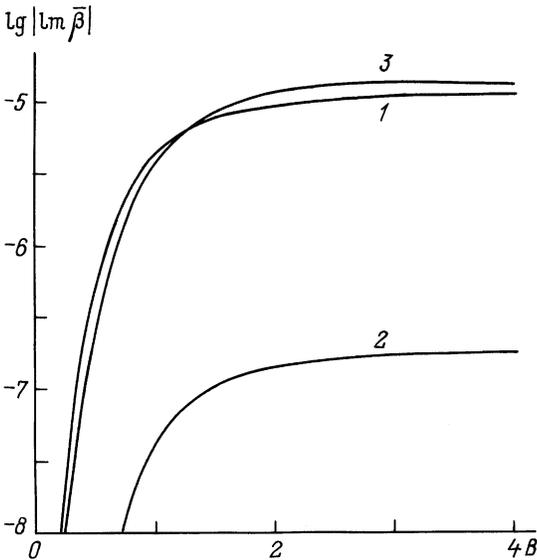
**Рис. 2.** Зависимости  $\text{Im} \bar{\beta}(B)$  для отожженных волноводов в X- и Y- (1 и 3) и Z-срезах  $\text{LiNbO}_3$  (2), соответствующие  $F = 2$ .
