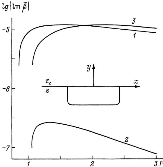
**Рис. 1.** Поперечное сечение исследуемых волноводов и зависимости коэффициентов мод неотжженных волноводов от их относительной ширины: 1, 3 — X- и Y-срезы; 2 — Z-срез  $\text{LiNbO}_3$ .
