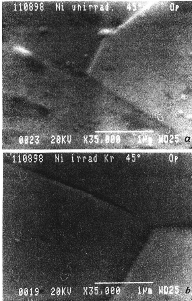
**Рис. 1.** Фотографии структуры поверхности поликристаллического Ni до (a) и после облучения (b) ионами  $^{86}\text{Kr}$  с энергией 305 MeV при флюенсе  $F \cdot t \approx 2 \cdot 10^{15}$  ion/cm<sup>2</sup>.
