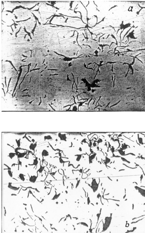
Рис. 2. Фотографии микроструктуры серого чугуна (увеличение 80): a — структура графитовых пластинок в плоскости шлифа до лазерной обработки; b — структура аморфного углерода в приповерхностном слое чугуна после лазерного воздействия.
