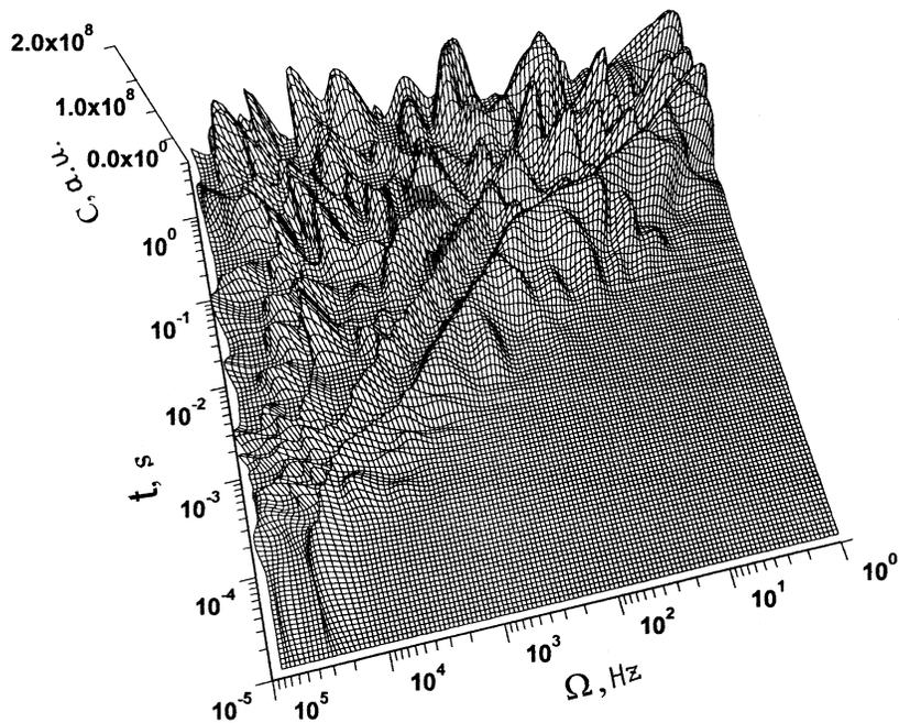
**Рис. 2.** Временная эволюция сверхнизкочастотных спектров максимальных значений поляризации зарядов при действии на цепочку осцилляторов длиной  $l = 10^{-3}$  м весьма слабым гармоническим электрическим полем при следующих параметрах:  $E_0 = 10^4 \div 10^5$  В/м,  $r = 10^{-6}$  м,  $a = 2.1 \cdot 10^{-6}$  м,  $\tau = 1.6 \cdot 10^{-5}$  с,  $\varepsilon_\infty = 8$ ,  $\varepsilon_s = 650$ ,  $c_0 = 10^5$ ,  $\beta = 1$ ,  $\xi = 10^{-33}$  и  $m = 1.6 \cdot 10^{-27}$  кг.
