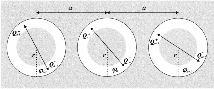
**Рис. 1.** Схематичное представление модельной системы в виде цепочки дипольных осцилляторов, изображающих колебания зарядов в оболочках (реальная толщина которых может быть порядка  $\sim 30 \div 300 \text{ \AA}$ ), вокруг частиц с диаметрами  $2r$ , расположенных друг от друга на расстоянии  $a$ .
