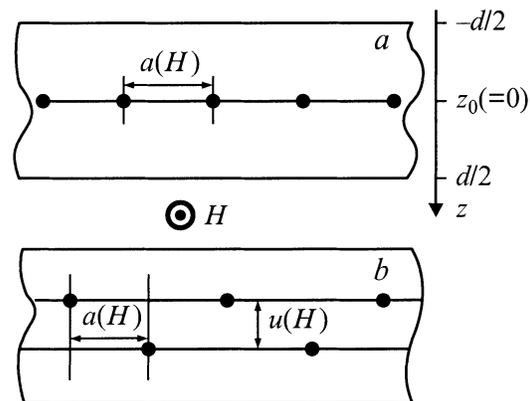
Рис. 1. Структура вихревой решетки в пленке в параллельном магнитном поле  $H$ : жирные точки — вихри; внешнее поле перпендикулярно плоскости рисунка.  $a$  — в поле  $H_{c1}^{(1)}(d) < H \leq H_{c1}^{(2)}(d)$  существует один ряд вихрей в центре пленки;  $b$  — в поле  $H_{c1}^{(2)}(d) < H \leq H_{c1}^{(3)}(d)$  происходит расщепление структуры на два вихревых ряда.
