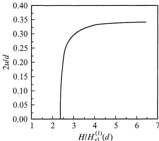
Рис. 3. Зависимость расстояния между вихревыми рядами  $u(H)$  от магнитного поля  $H$ .
