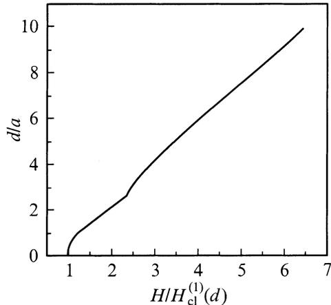
Рис. 2. Зависимость расстояния между соседними вихрями  $a(H)$  от внешнего поля  $H$ .
