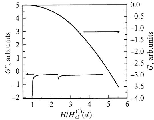
Рис. 4. Полевые зависимости свободной энергии пленки и ее второй производной по полю.
