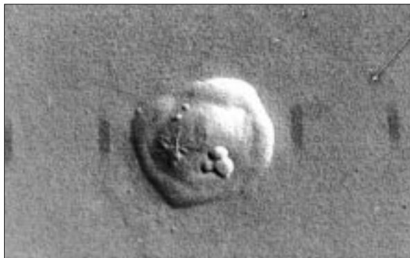
Рис. 4. Микронарушения на анодной поверхности слоя кристалла NaCl в окрестности канала переноса заряда.
