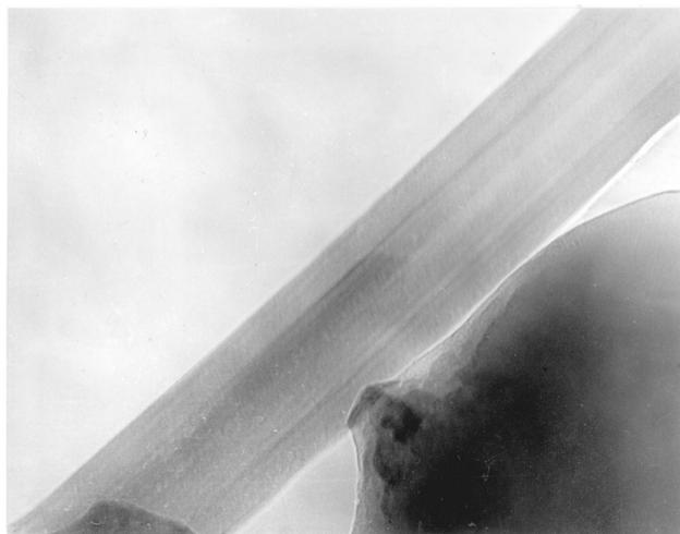
Микрофотография углеродной нанотрубки, полученной из поливинилового спирта в среде  $\text{H}_2\text{V}_{10}\text{Mo}_{02}\text{O}_{31}$ .
