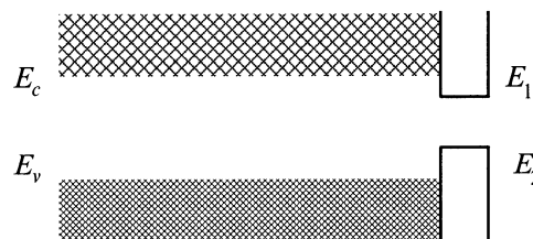
Рис. 1. Зоны поверхностных состояний ионного типа [1]: E_c — край зоны проводимости, E_v — край валентной зоны, E_1 — край зоны поверхностных состояний акцепторного типа; E_2 — край зоны поверхностных состояний донорного типа.
