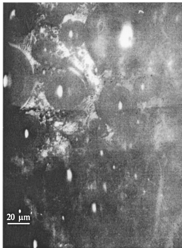
Рис. 8. Следы пластического течения и микротрещины на поверхности разрушения стеклопластика.
