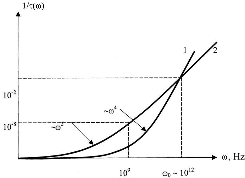
Схематическое изображение частотной зависимости обратного времени рассеяния. 1 — закон Рэля, 2 — предсказанная в статье возможная зависимость обратного времени рассеяния от частоты монохроматического излучения в диапазоне весьма малых частот (по шкале длин волн это соответствует диапазону примерно в сотни и более метров). Частота  $\omega_0 = (Ac/v)^{1/2}$  и о ней подробно говорится в тексте.
