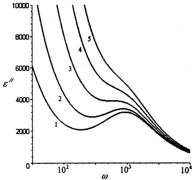
**Рис. 1.** Зависимость мнимой части диэлектрической проницаемости от логарифма частоты приложенного электрического поля. Для всех кривых  $\tau = 10^{-3}$  с,  $\varepsilon_{\infty} = 1000$ ,  $\Delta\varepsilon = 6000$ . Частота  $\omega$  в ( $\text{с}^{-1}$ ). 1 —  $\sigma = \sigma_1/4$ , 2 —  $\sigma = \sigma_1/2$ , 3 —  $\sigma = \sigma_1$ , 4 —  $\sigma = 1.7\sigma_1$ , 5 —  $\sigma = 2.5\sigma_1$ .
