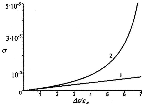
**Рис. 3.** Зависимость удельной электропроводности среды на низких частотах от отношения  $\Delta\epsilon/\epsilon_\infty$ . Значения удельной электропроводности  $\sigma$  в (СМ). Для всех кривых  $\tau = 10^{-3}$  с,  $\epsilon_\infty = 1000$ . 1 —  $\sigma = \sigma_1$ , 2 —  $\sigma = \sigma_2$ .
