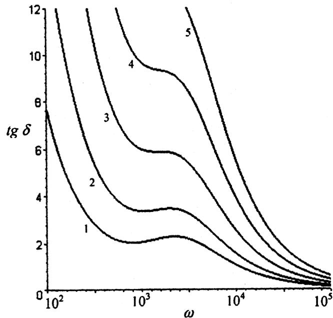
**Рис. 2.** Зависимость тангенса угла диэлектрических потерь от логарифма частоты приложенного электрического поля. Для всех кривых  $\tau = 10^{-3}$  с,  $\epsilon_{\infty} = 1000$ ,  $\Delta\epsilon = 6000$ . Частота  $\omega$  в  $(\text{с}^{-1})$ . 1 —  $\sigma = \sigma_2/4$ , 2 —  $\sigma = \sigma_2/2$ , 3 —  $\sigma = \sigma_2$ , 4 —  $\sigma = \sigma_2$ , 5 —  $\sigma = 2.5\sigma_2$ .
