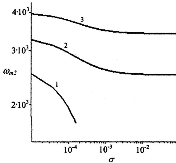
**Рис. 4.** Зависимость частоты максимума  $\text{tg}(\omega)$  от удельной электропроводности среды на низких частотах. Для всех кривых  $\tau = 10^{-3}$  с,  $\epsilon_{\infty} = 1000$ . Частота  $\omega_{m2}$  в  $(\text{с}^{-1})$ . Значения удельной электропроводности  $\sigma$  в (СМ). 1 —  $(\Delta\epsilon/\epsilon_{\infty}) = 6$ , 2 —  $(\Delta\epsilon/\epsilon_{\infty}) = 10$ , 3 —  $(\Delta\epsilon/\epsilon_{\infty}) = 15$ .
