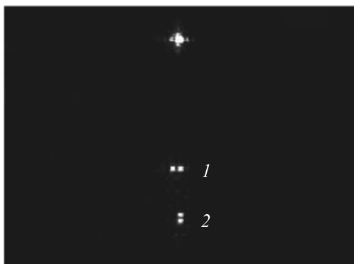
Рис. 2. Выходные сигналы анализатора при подаче на вход сигналов с частотами, соответствующими разрешению по точной 1 и грубой 2 осям.
