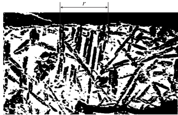
Рис. 1. Структура кремния в контактном материале после бомбардировки поверхности расплава отрицательными частицами газоразрядной плазмы (косой шлиф контакта золото–никель–кремний, выполненный под углом 7^\circ , U = 3.6 \text{ kV} , J = 2.8 \text{ mA} , r — зона действия бомбардировки отрицательных частиц потока газоразрядной плазмы).
