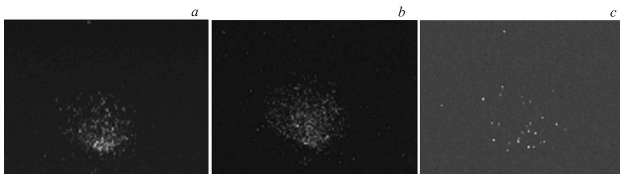
**Рис. 3.** Фотографии различных стадий коронного разряда: *a* — первая наносекунда после пробоя промежутка, *b* — интервал времени 4–7 ns, *c* — 7–10 ns. Высоковольтный электрод находится снизу кадра.
