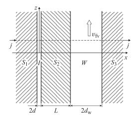
Слоистая структура  $S_1IS_2WS_3$ . 2d,  $2d_w$  и L — толщины ДП, волновода и сверхпроводника  $S_2$ , j — плотность тока, протекающего через всю структуру,  $v_{\rm fv}$  — скорость быстрого вихря.
