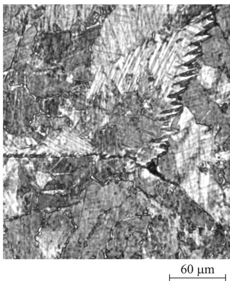
Рис. 11. Крупнозернистая структура сплава  $Ni_{49}Mn_{51}$  после закалки от  $850^{\circ}C$ .
