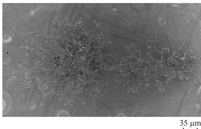
Рис. 1. Электронно-микроскопическое изображение автографа канала разряда на катоде.
