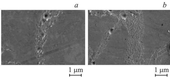
**Рис. 4.** Электронно-микроскопические изображения отдельных дорожек: *a* — на катоде, *b* — на аноде.
