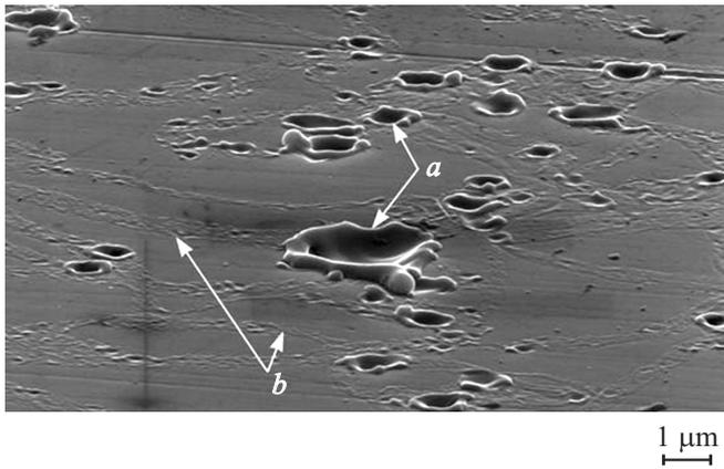
**Рис. 2.** Электронно-микроскопическое изображение фрагмента автографа канала разряда на плоском катоде: *a* — микрократеры, *b* — дорожки.
