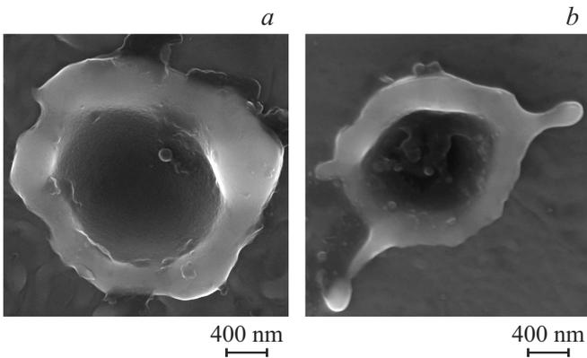
**Рис. 3.** Электронно-микроскопические изображения микрократеров на плоском электроде: *a* — на катоде, *b* — на аноде.
