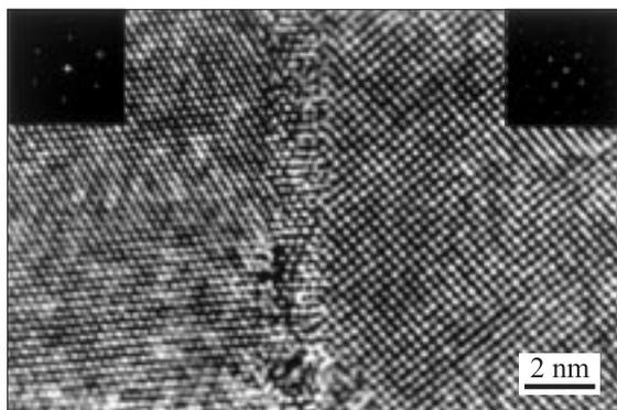
**Рис. 6.** Высокоразрешающее изображение сплава  $Zr_{50}Ti_{16}Cu_{15}Ni_{19}$  после термической обработки при  $T = 773$  К.
