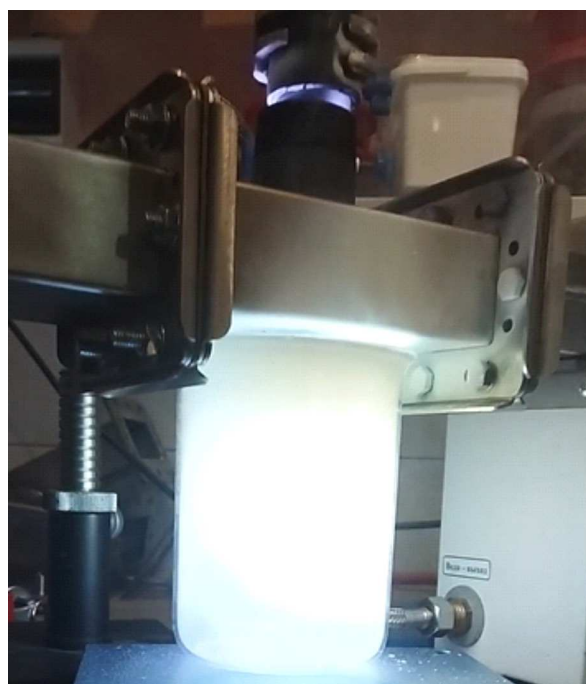
Рис. 1. Демонстрация процесса синтеза микроструктур ZnO в эксперименте с использованием микроволновой плазмы.
