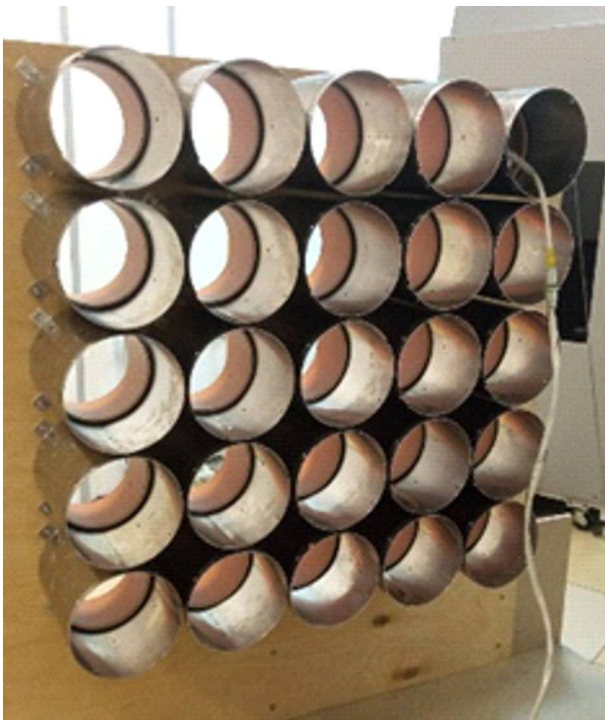
Рис. 9. Макет сборки из 25 экранов для сцинтилляторного детектора спектров нейтрино НИЦ „Курчатовский институт“ – ПИЯФ.
