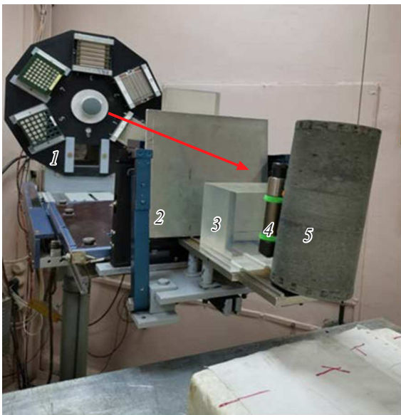
Рис. 2. Схема облучения полимерного композита на фазотроне (красной стрелкой указано направление выхода пучка протонов из канала фазотрона), где: 1 — фазотрон, 2 — алюминиевый экран толщиной 4 мм, 3 — водяной поглотитель (в данном эксперименте не использовался), 4 — датчик „ПИЛЛЕ-МКС“ и сборка с пассивными детекторами ТЛД и ТТД, 5 — полимерный композит.
